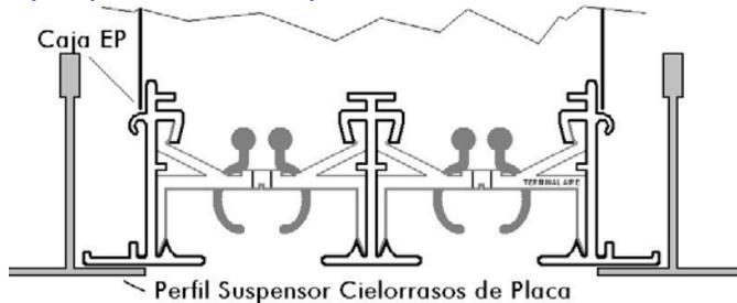
En este tipo de montaje, el difusor se sujeta a la caja adaptadora EP por remaches y todo el conjunto se monta por encima del perfil "T" invertida, simplemente apoyándolo sobre las mismas.
