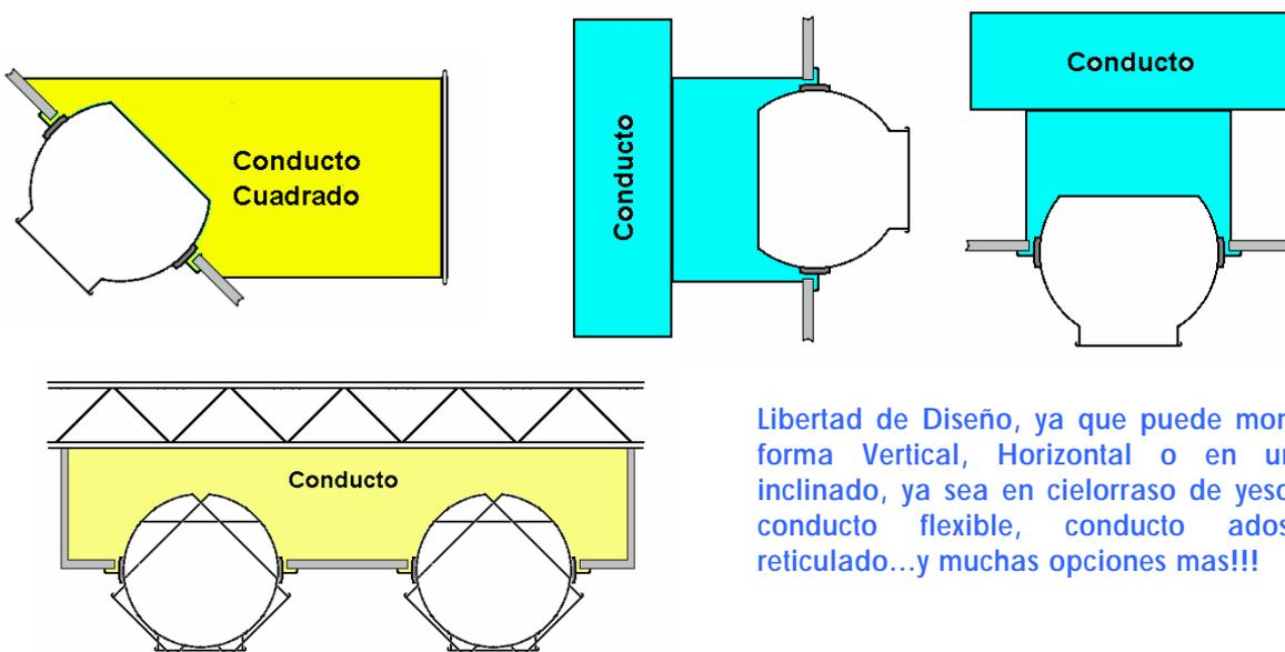
Libertad de Diseño, ya que puede montarse en forma Vertical, Horizontal o en un plano inclinado, ya sea en cielorraso de yeso, pared, conducto flexible, conducto adosado a reticulado...y muchas opciones mas!!!
